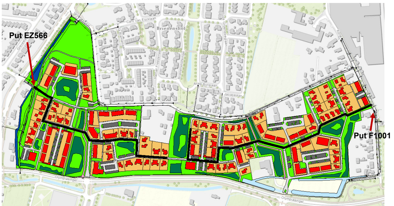
Figuur 5.1 Langste transportafstand naar bestaande riolering.
