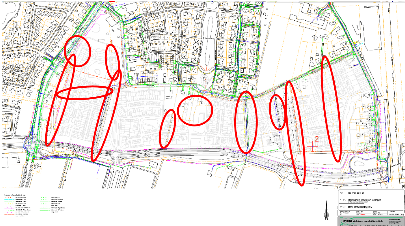
Figuur 2.7 Conflicten met bestaande kabels en leidingen.
