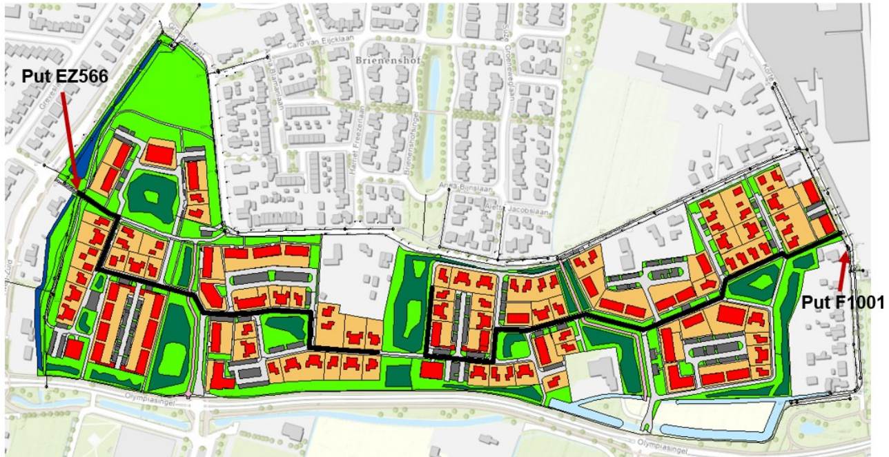
Figuur 6.4 Langste transportafstand naar bestaande riolering
