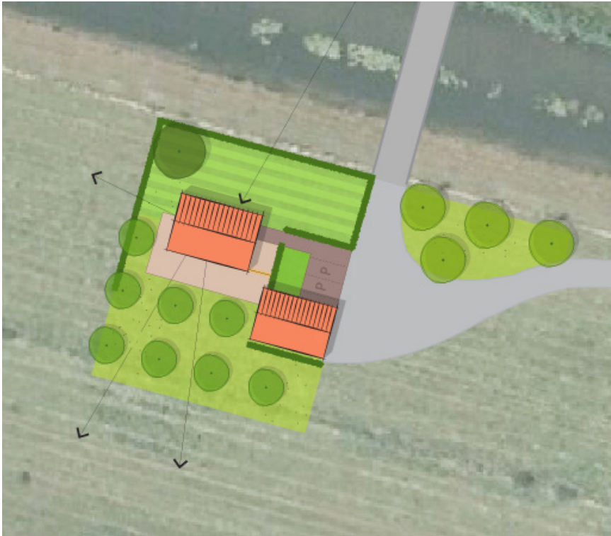
Afbeelding 3.4 Voorbeelduitwerking met woning van 600 \text{ m}^3 (grondvlak 100 \text{ m}^2 ) en schuur met opp. van 75 \text{ m}^2
