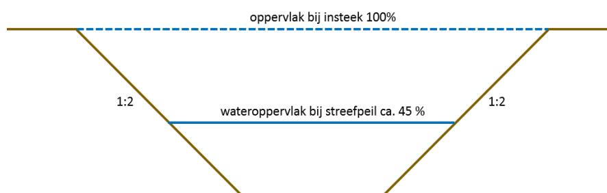
Afbeelding 4.2 Schematische weergave watergang
