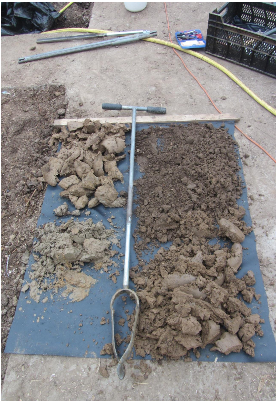
Figuur 14: Boring 3, geplaatst met een 12 cm handboor (in kas), ooivaaggrond
