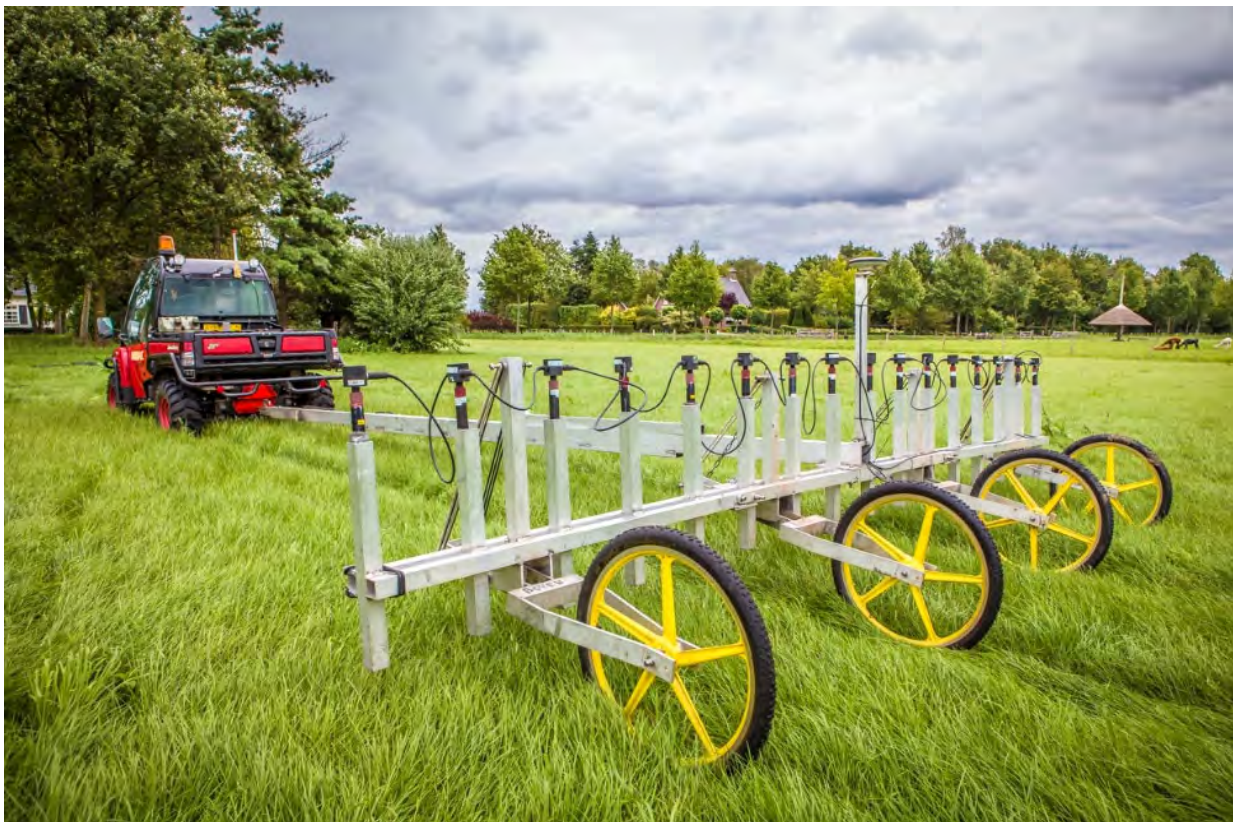
Figuur 3: Detectievoertuig zoals deze gebruikt is voor het uitvoeren van de computerondersteunde oppervlakedetectie.
