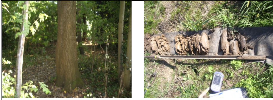
Afb. 13 Overzicht van het noordoostelijke deel van het plangebied. (bos en tuin). De linker foto toont de dikke bomen die hier groeien. De rechterfoto toont boring 1 met op 1,10 m een humeuze laklaag.
