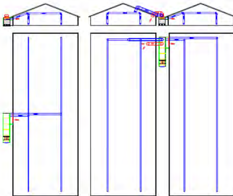
Plattegrond en dwarsdoorsnede bij toepassen van warmtewisselaar met buizen systeem
