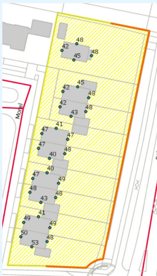
figuur 6: locatie geluidsscherm (oranje) met de cumulatieve geluidsbelasting op de begane grond waarden L_{den} in dB
