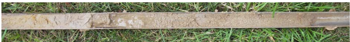
Figuur 14: Het grove zand dat onderin elke boring is aangetroffen en vanaf een diepte van twee-en-een-halve meter uit de boor stroomt.
