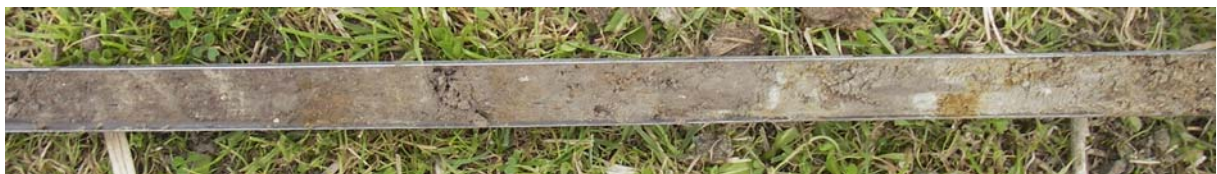
Figuur 13: Het rommelige pakket humusrijke, geoxideerde, zandige klei dat bovenin elke boring is aangetroffen
