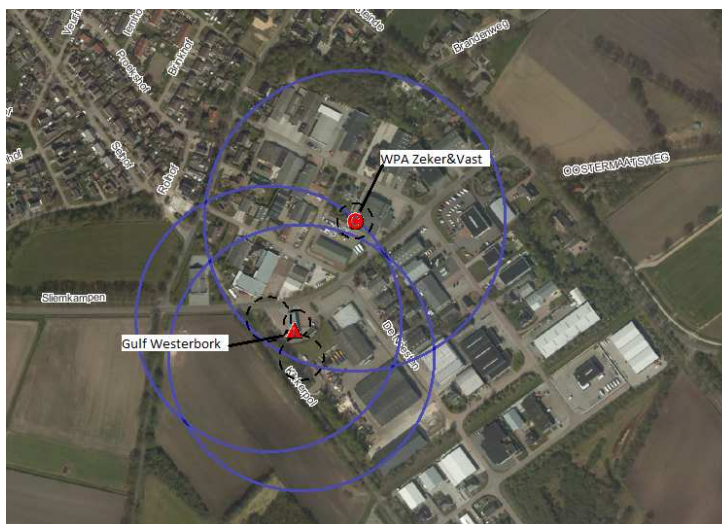
Figuur 5.3: LPG-tankstation Gulf Westerbork en WPA Zeker&Vast. De blauwe cirkels zijn de invloedsgebieden van beide risicovolle objecten.
