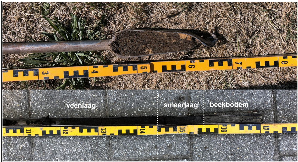
Figuur 13. Beilen, Torenlaan - Nassaukade: Resultaten booronderzoek. Boven: het verstoorde pakket in boring 2 op een diepte van 50 tot 65 centimeter beneden maaiveld en onder: de veenbodem en beekbodem in boring 6 op een diepte van 110 tot 170 centimeter beneden maaiveld.
