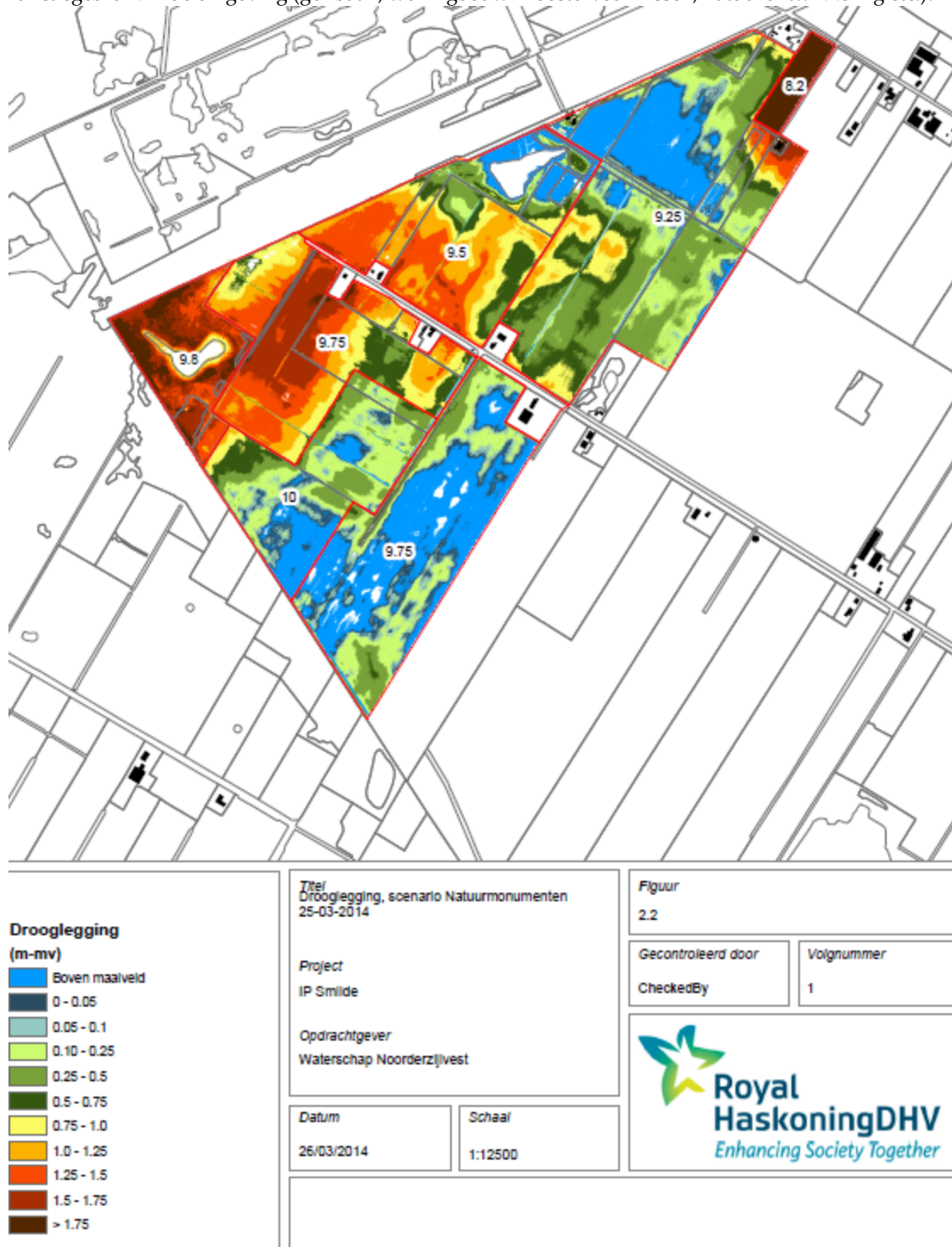
Afbeelding 17: Droogleggingskaart (verschil tussen het maaiveld en het oppervlaktewaterpeil) van de Zeven Blokken (RHDHV, 2014).
