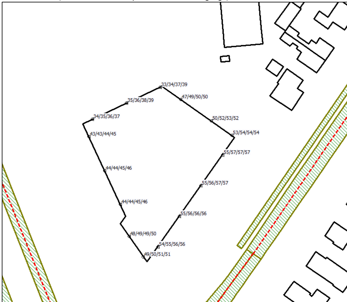
Figuur 5.1: overzicht van de berekende geluidbelasting L_{den} in dB vanwege de Linthorst Homanweg (inclusief 5 dB aftrek op basis van artikel 110g Wgh)
