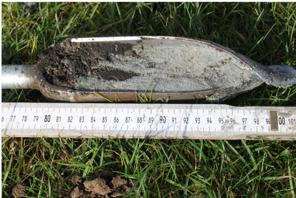
Figuur 2: Boring 3, overgang veen naar onderliggende zandlaag.
