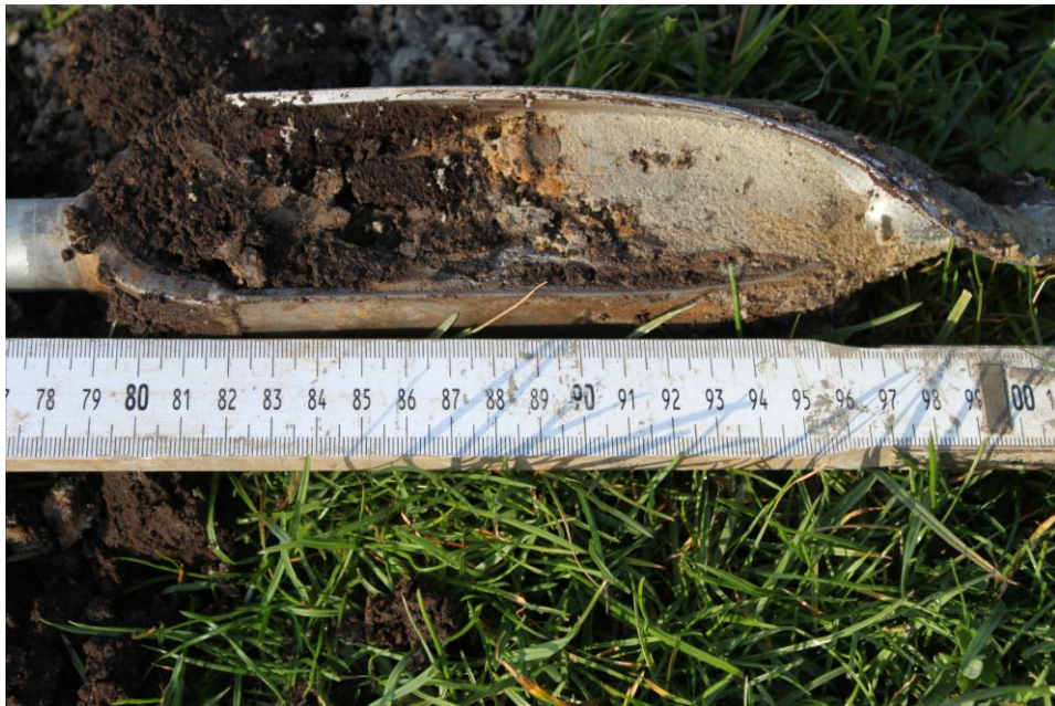
Figuur 4: Boring 1, overgang veen naar onderliggende zandlaag.
