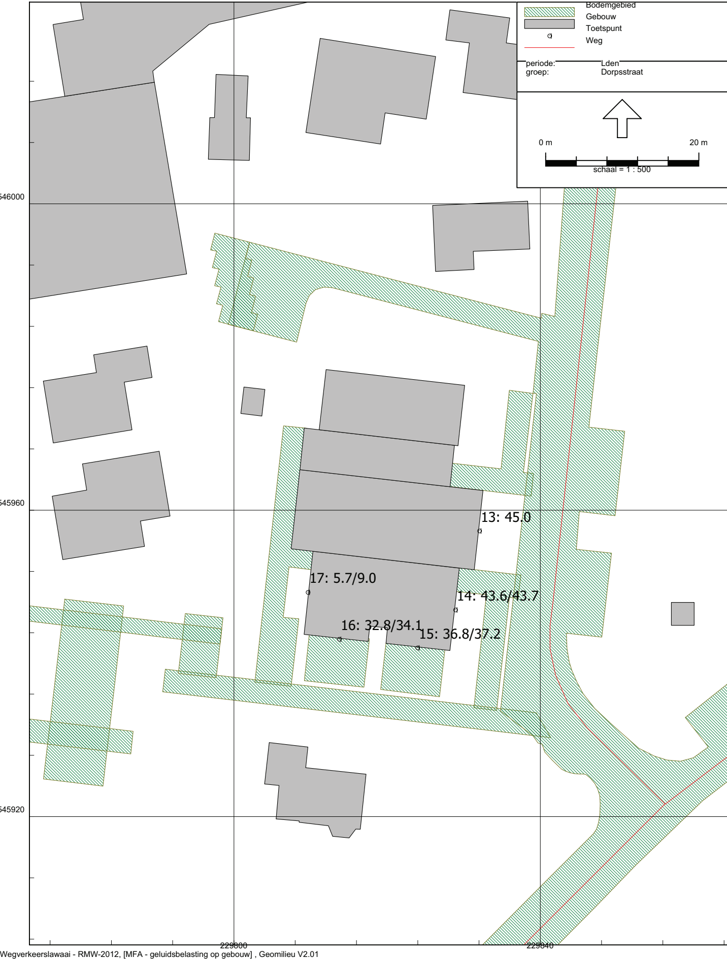
Overzicht berekende Lden-geluidsbelasting (excl. aftrek ex art. 110g Wgh) vanwege het wegverkeer op de Dorpsstraat
