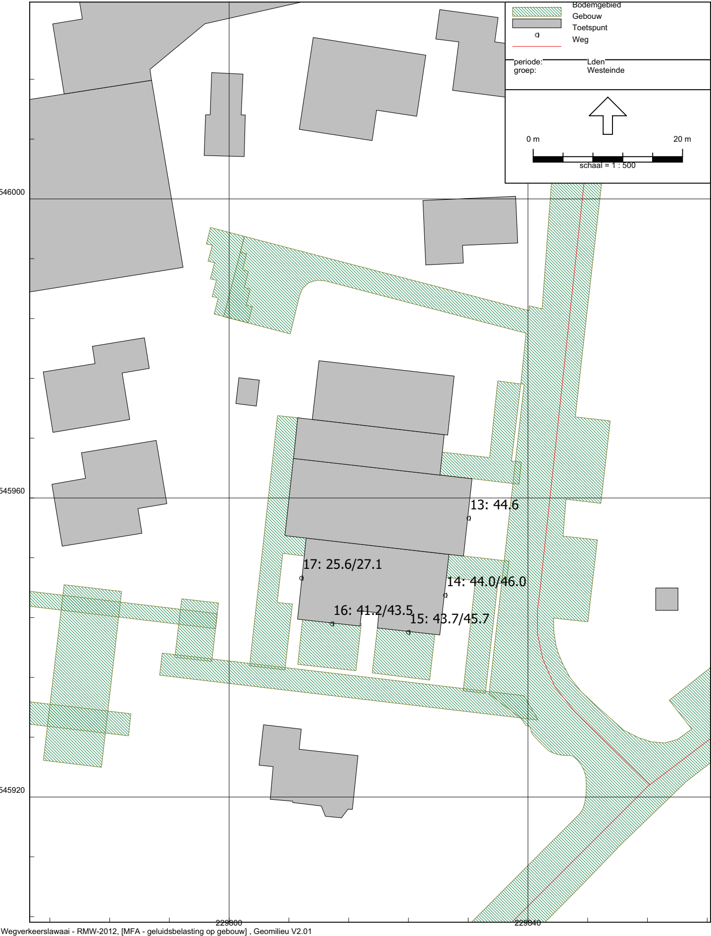
Overzicht berekende Lden-geluidsbelasting (excl. aftrek ex art. 110g Wgh) vanwege het wegverkeer op de Westeinde
