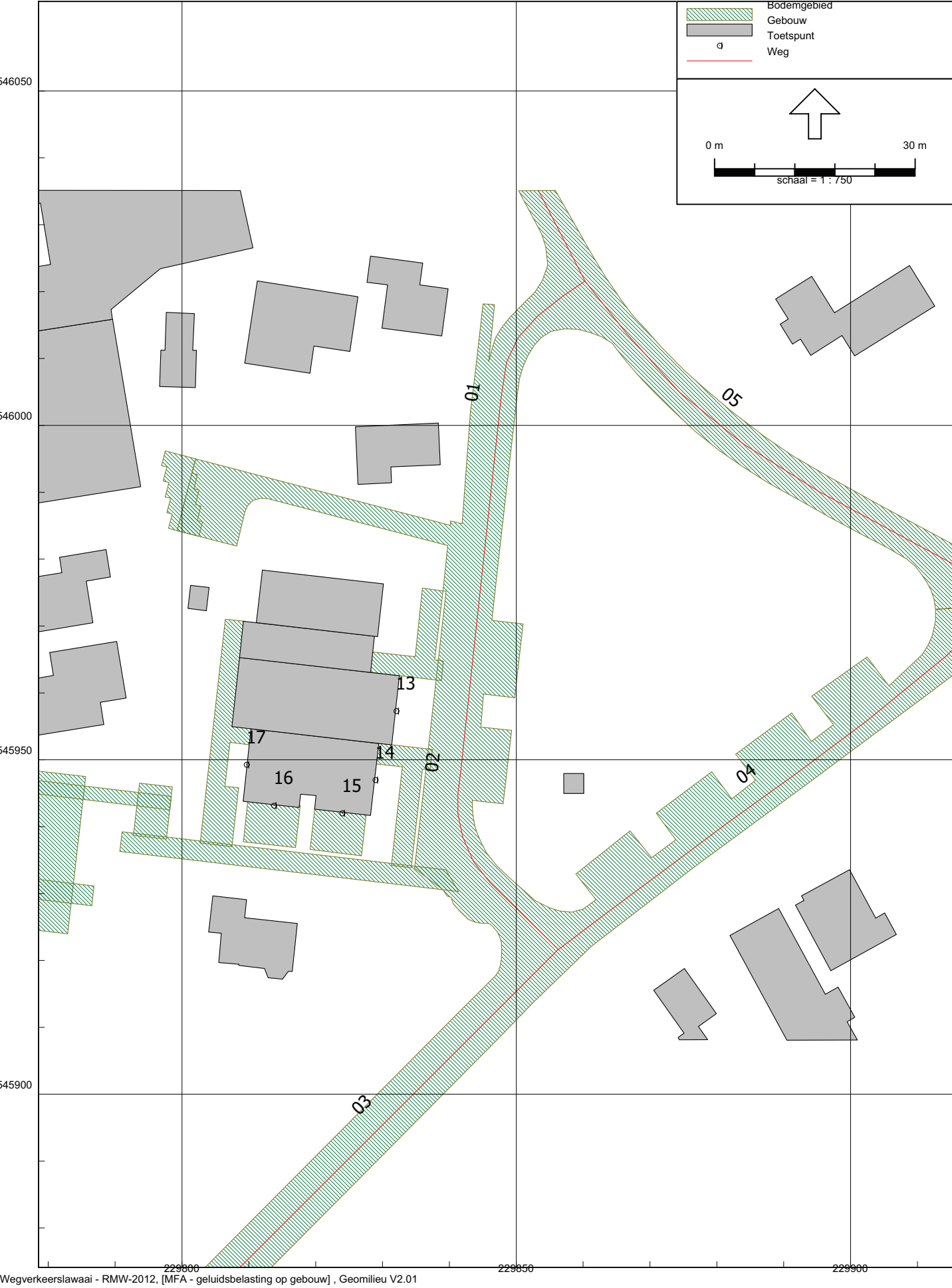
Overzicht van het rekenmodel met de ingevoerde objecten, toetspunten en wegen
