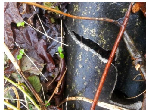
Foto 4: Stuk (asbest) golfplaat
