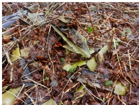
Foto 4: Stuk (asbest) golfplaat
