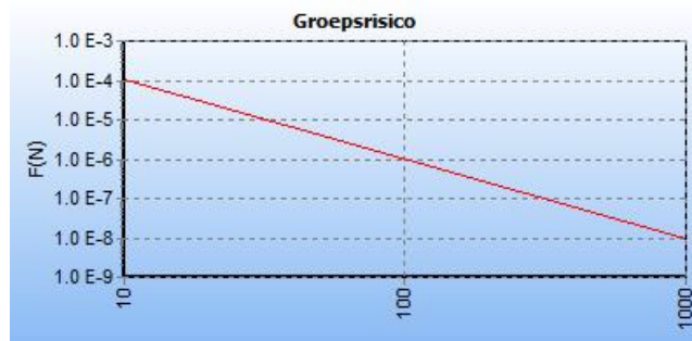
Figuur 5.3: fN-curve van het berekende groepsrisico (bestaande en nieuwe situatie) met de oriëntatiewaarde (rode lijn)
