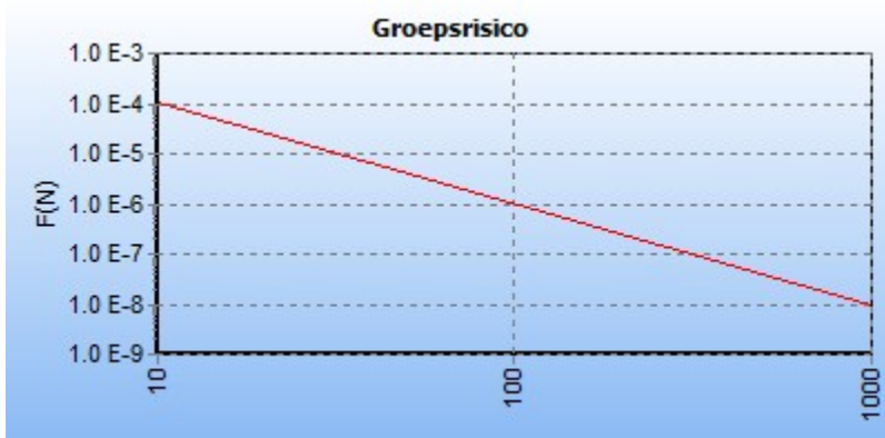
5.2 Figuur 5.2 FN curve voor N-521-43 van N.V. Nederlandse Gasunie voor de kilometer tussen stationing 0.00 en stationing 40.00
