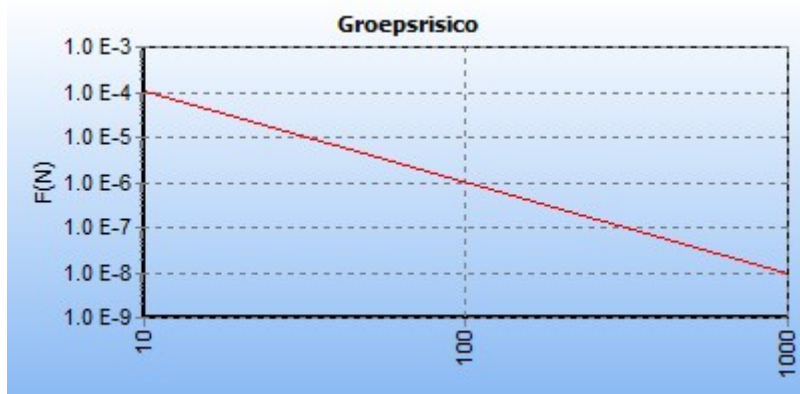
5.4 Figuur 5.4 FN curve voor N-521-50 van N.V. Nederlandse Gasunie voor de kilometer tussen stationing 0.00 en stationing 1000.00
