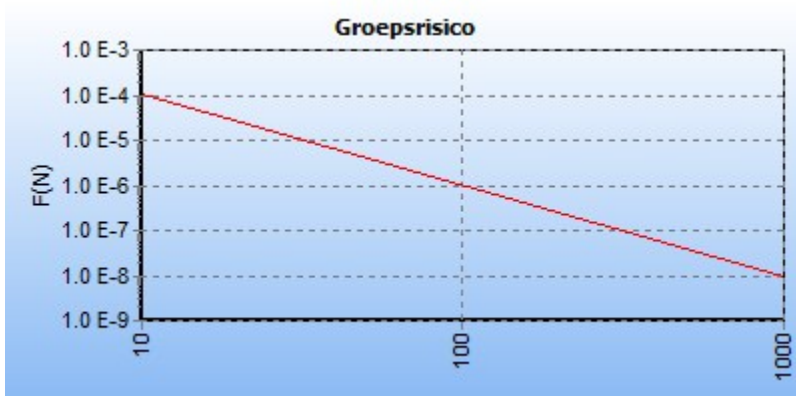
5.2 Figuur 5.2 FN curve voor N-521-43 van N.V. Nederlandse Gasunie voor de kilometer tussen stationing 0.00 en stationing 40.00
