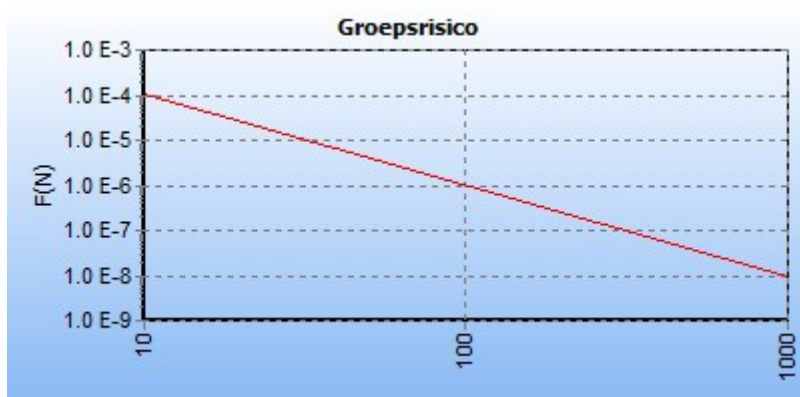
5.4 Figuur 5.4 FN curve voor N-521-50 van N.V. Nederlandse Gasunie voor de kilometer tussen stationing 0.00 en stationing 1000.00
