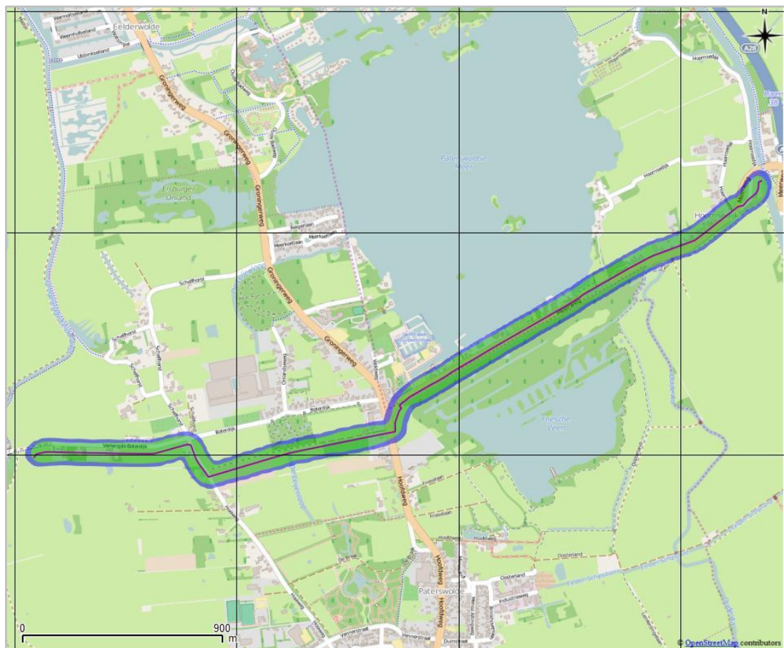
Figuur 8 Ligging van gastransportleiding N-507-36 (paars) in de huidige situatie. De plaatsgebonden risicocontouren rondom de leiding zijn, wanneer aanwezig, weergegeven met de volgende kleuren:
