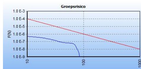
Figuur 5.8: fN-curve voor een kilometer leiding A-540-14 Nieuwe situatie dus met woonboten en Camperplaatsen
