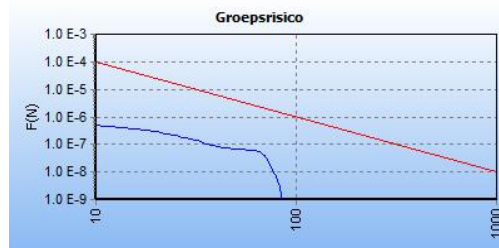
Figuur 5.10: fN-curve voor een kilometer leiding A-540. Bestaande situatie dus met woonboten en Camperplaatsen
