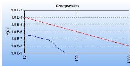
Figuur 5.6: fN-curve voor een kilometer leiding A-540. Bestaande situatie dus zonder woonboten en Camperplaatsen
