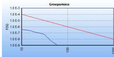
Figuur 5.4: fN-curve voor een kilometer leiding A-540-14. Bestaande situatie dus zonder woonboten en Camperplaatsen
