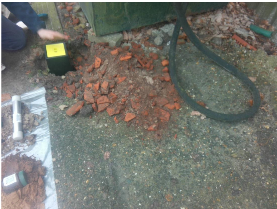
Afbeelding 7. Volledige dakpan laag bij Gasolietank aan de oostzijde (Peilbuis/boring G02).
