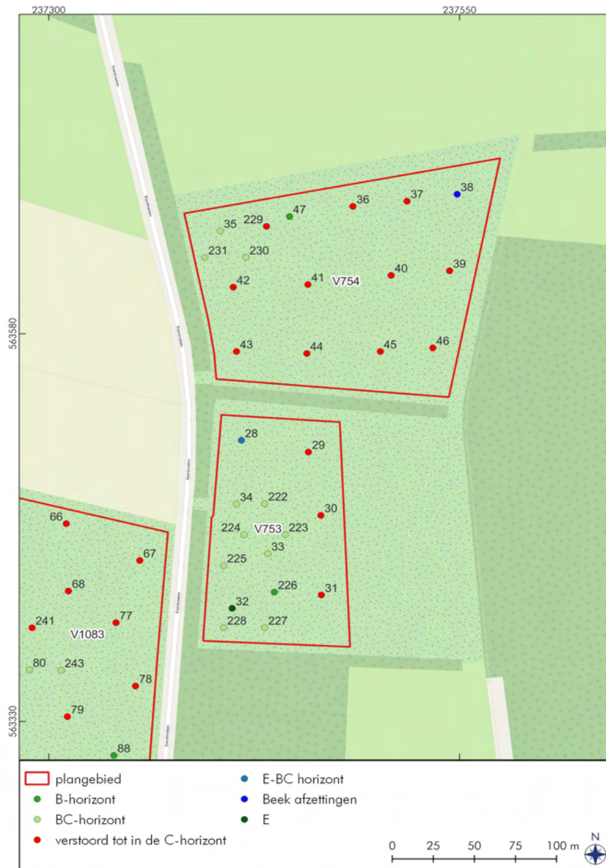
Figuur 19. Oudemolen: overzicht boorpunten van de percelen V753 en V754.
