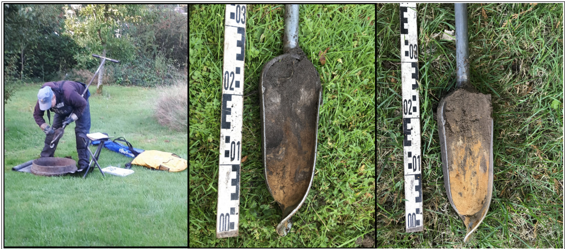
Figuur 15. Eelde, Vosbergerlaan 20: Afbeelding met links het plaatsen van Boring 4. Midden: de opgeboorde grond uit Boring 3 met het verstoorde/vergraven, gevlekte pakket op een diepte van circa 65 centimeter beneden maaiveld. Rechts: eveneens een verstoorde pakket in Boring 4.
