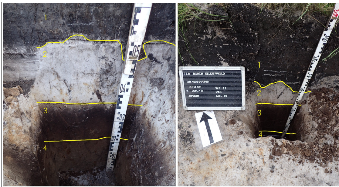
Figuur 7. Eelderwolde, Businesspark Ter Borch: Twee bodemprofielen uit de hoger gelegen delen van het onderzoeksgebied, links een detail van het profiel van proefsleuf 4 en rechts het profiel van proefsleuf 11: 1= veraard veen, 2= E-horizont, 3= B-horizont, 4= C-horizont. Zichtbaar is de verstoorde overgang van het veraarde veen naar de E-horizont.
