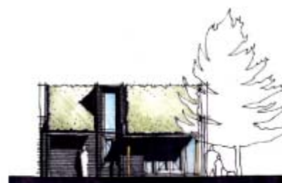
Voorgevel Groen dak, lijn. Eco-ler groen (sedumbakken op golfplaat)
