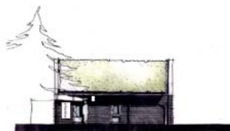
Achtergevel Groen dak, lijn. Eco-ler groen (sedumbakken op golfplaat)
