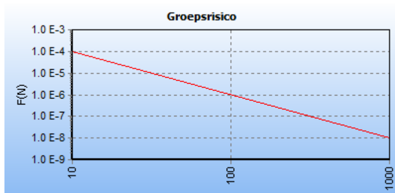
Figuur 5.2: fN-curve van het berekende groepsrisico voor zowel de bestaande en nieuwe situatie met de oriëntatiewaarde (rode lijn).
