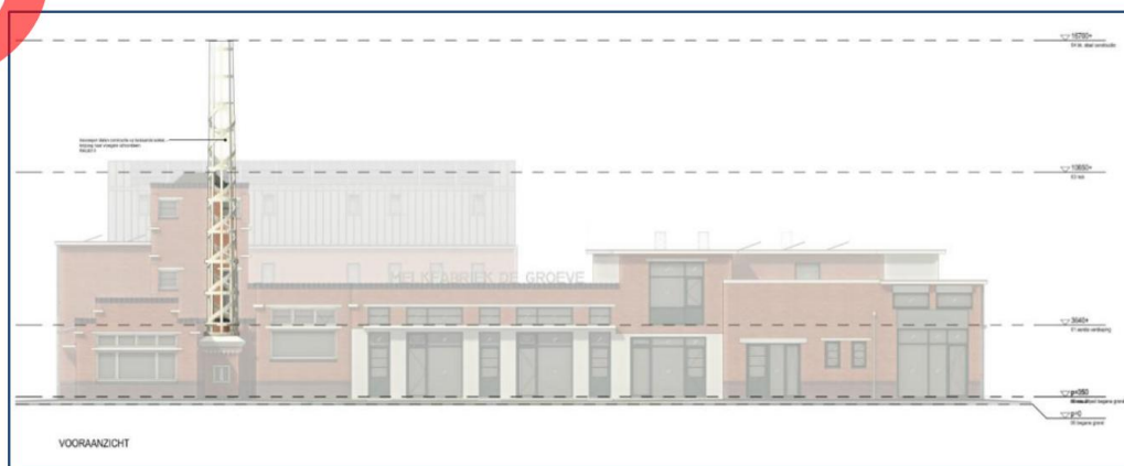
Figuur 2.11: Een weergave van de stalen constructie op de bestaande schoorsteenvoet (sokkel).
