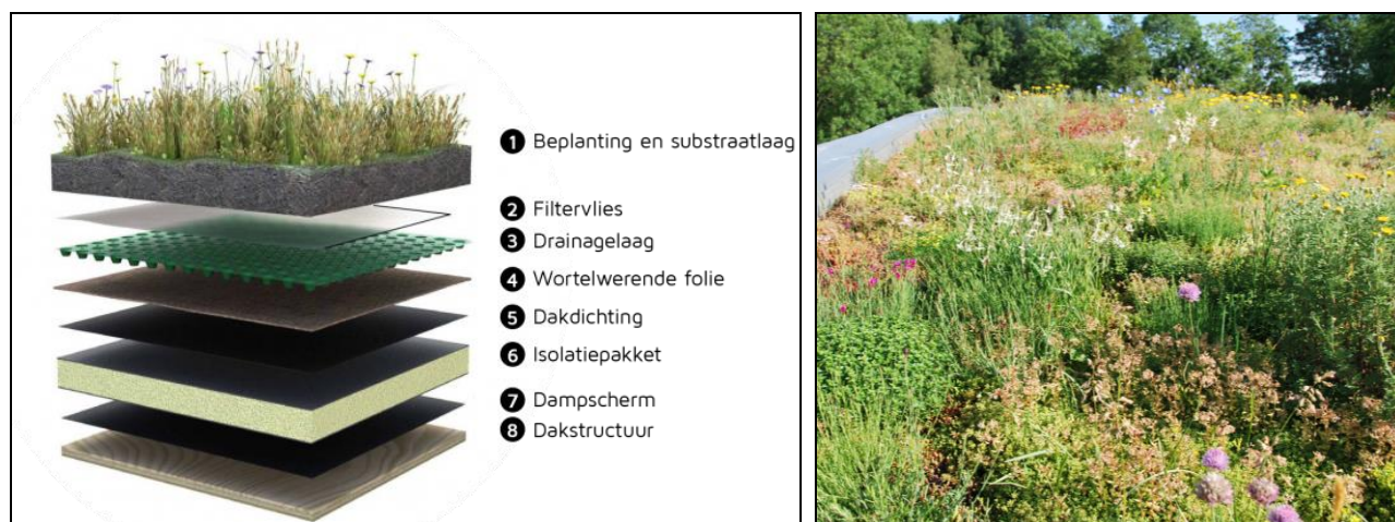
Afbeelding 8: Systeem opbouw groendak [Bron: Energids en groenbedekking.net]
