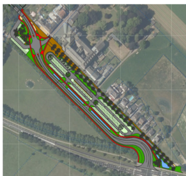
Variant 3a Fietspad: vrijliggend, eenrichting, beide zijde van de N595
