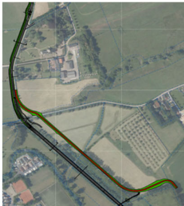
Variant 1b Barokke rechte lijn: fietstracé parallel aan de N595, zo dicht mogelijk op N595
