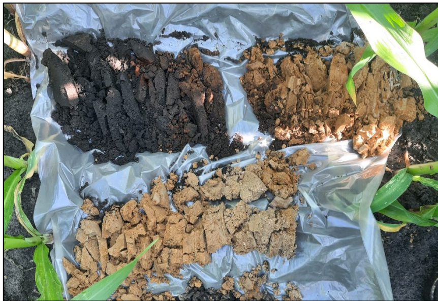
Figuur 7. Foto van boring 4. Boorprofiel. De leesrichting is van linksboven naar rechtsonder (0 – 100 centimeter) (Foto: 10 juli 2023).
