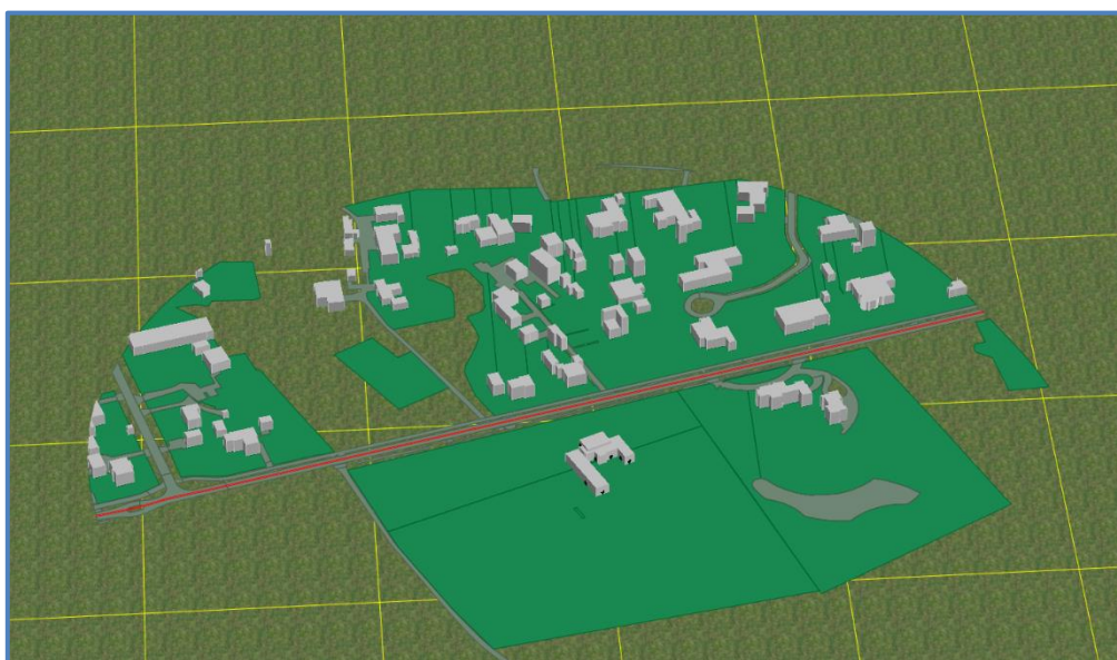
Afbeelding 5. Rekenmodel wegverkeerslawai, 3d-weergave
