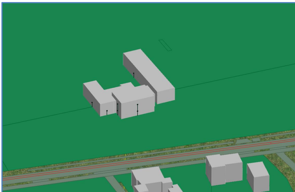
Afbeelding 4. Rekenmodel wegverkeerslawai, 3d-weergave
