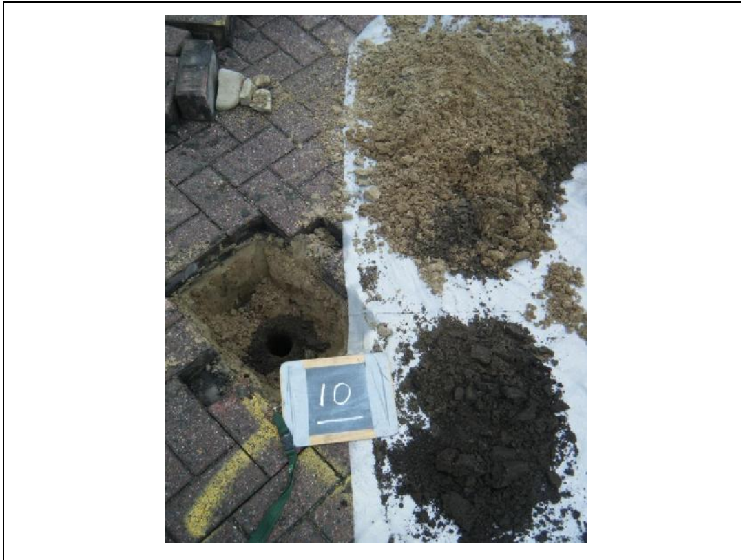
Foto 13. Asbestgat 10 en opgegraven en gezeefd materiaal asbestgat 10
