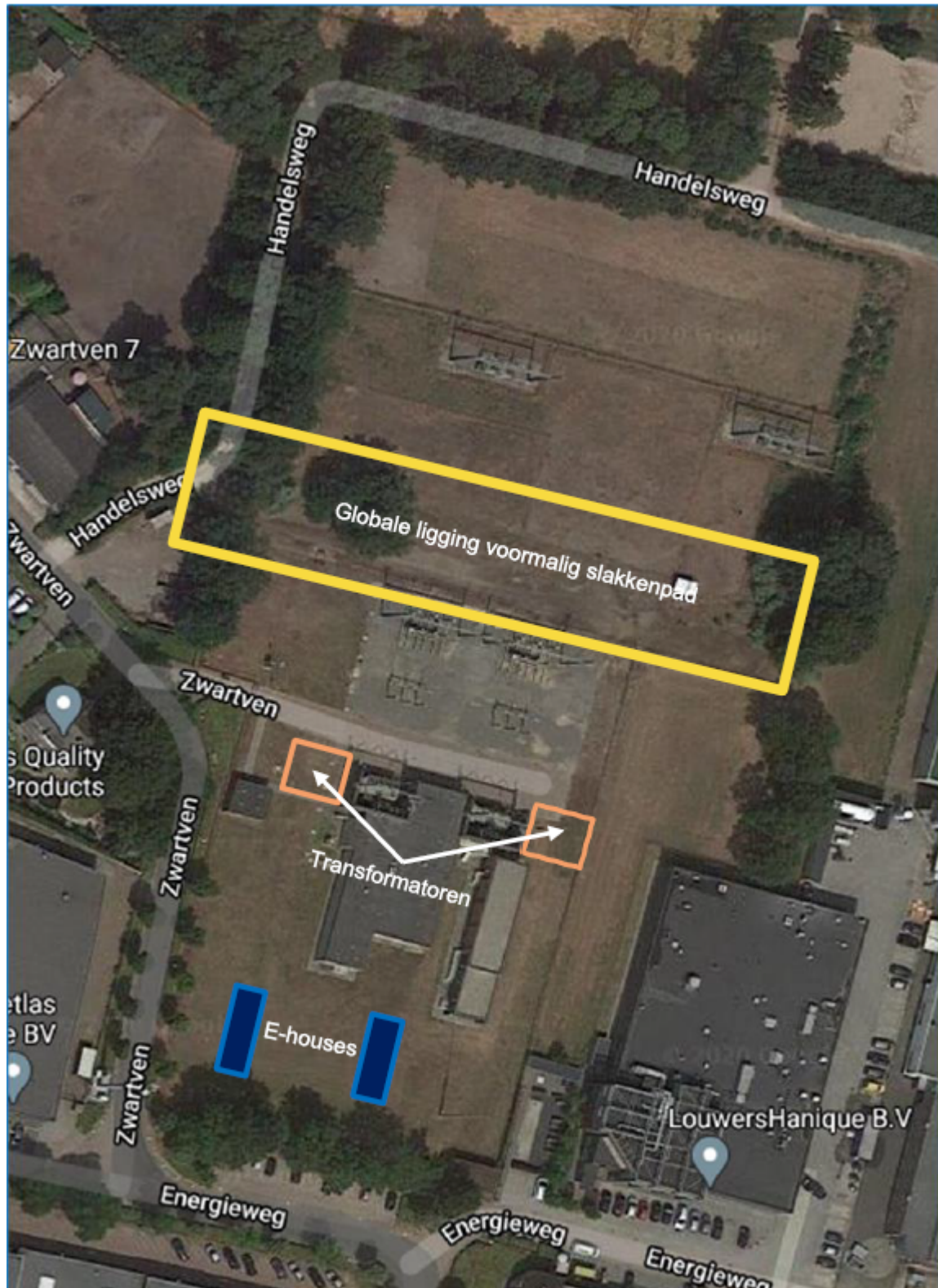
Abbeelding 9 luchtfoto HS-station Hapert met globale ligging nieuwbouwlocaties en voormalig slakkenpad
