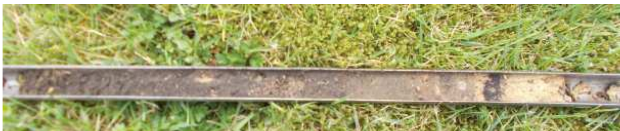
Figuur 17: Foto van de menglaag (midden) zoals deze op de boorpunten 2, 4, 5, 6, 8 en 9 is aangetroffen
