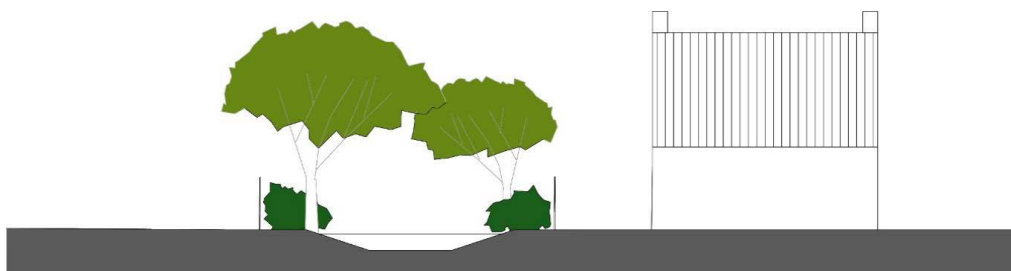
Dwarsprofiel groenzone zuidwestzijde met geïntegreerde waterberging
