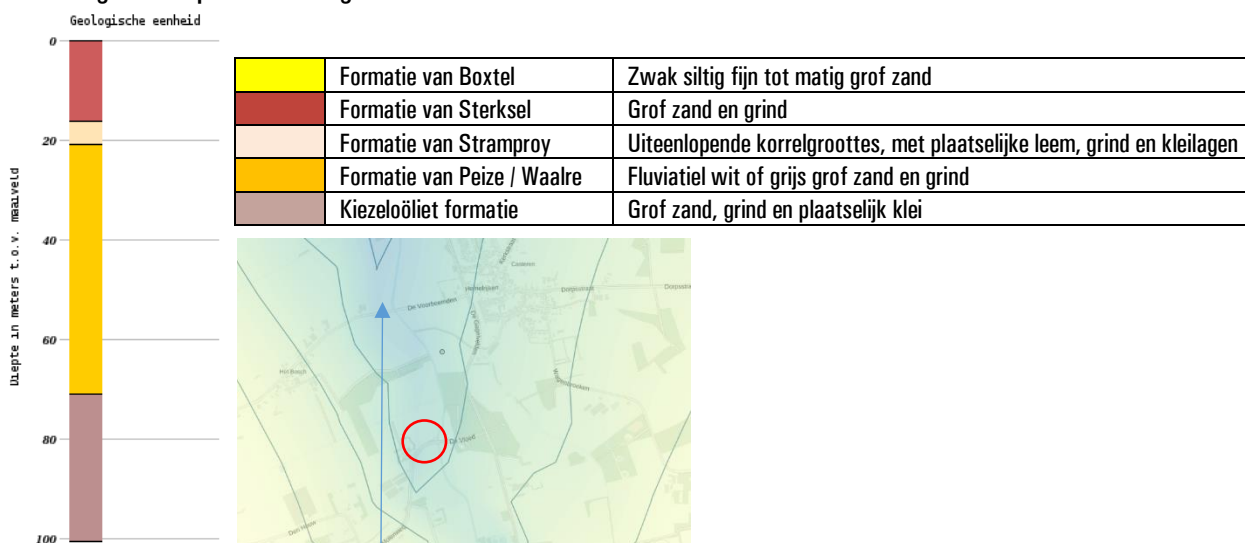
Figuur A: opbouw ondergrond.
