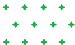
Afbeelding 3: planten in driehoeksverband, met een plantafstand van 1,5 * 1,5 m hart op hart.
