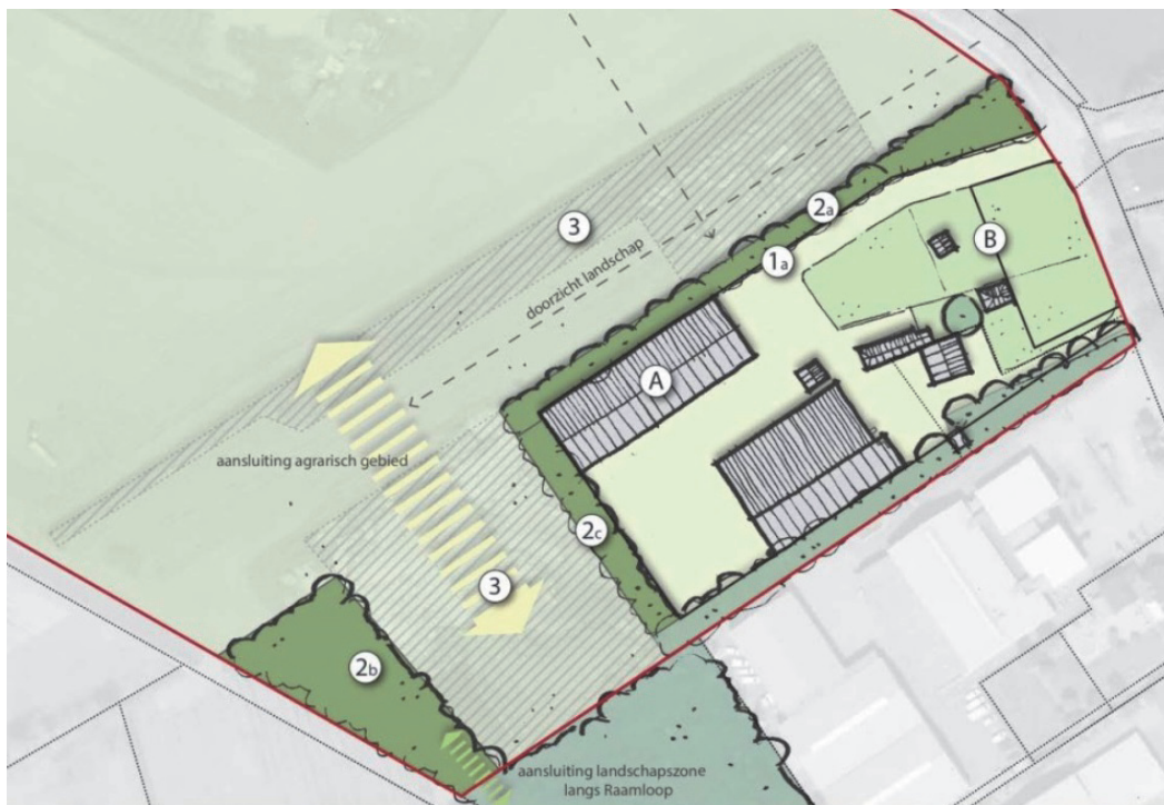
Figuur 7: Gewenste situatie. 1; vormverandering bestemmingsvlak en bouwvlak, 2; aanplant nieuwe beplanting, 3; verwijderen aanwezige verhardingen en beplantingen
