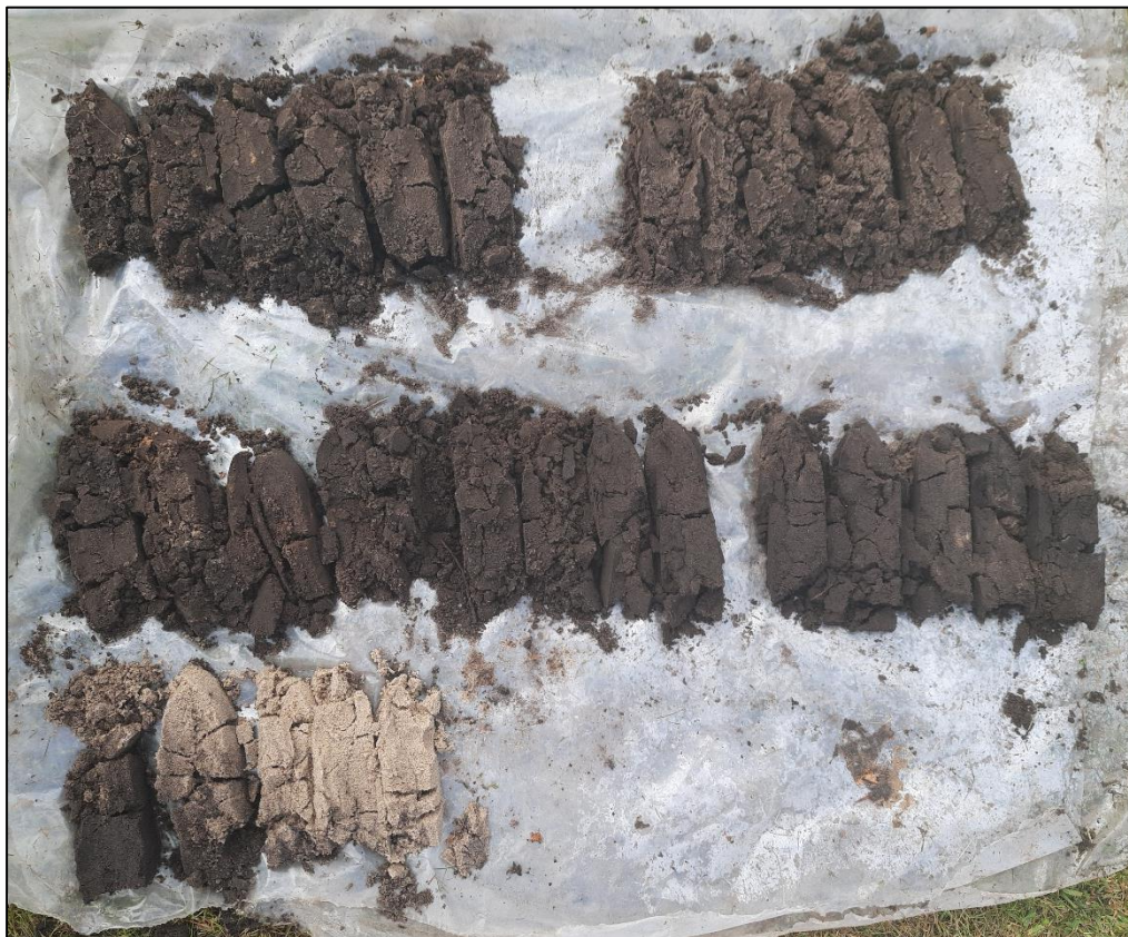
Figuur 10: Foto van boring 3.1 (0 – 220 centimeter, deelgebied 1b). De leesrichting is van linksboven naar rechtsonder. (Foto: 28 mei 2021).
