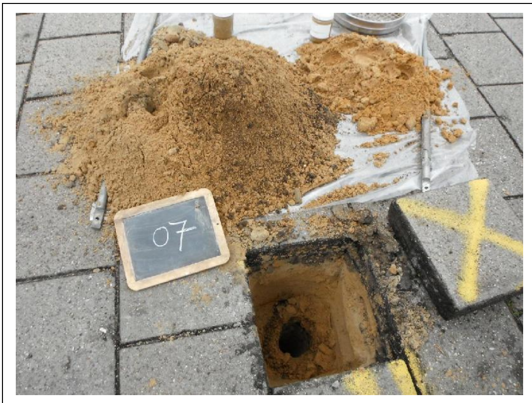
Foto 10. Asbestgat 7 en opgegraven en gezeefd materiaal asbestgat 7
