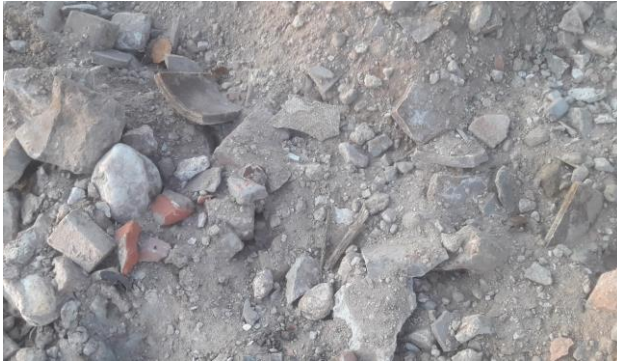
Foto 5+6: fragmenten asbest onder vloer
