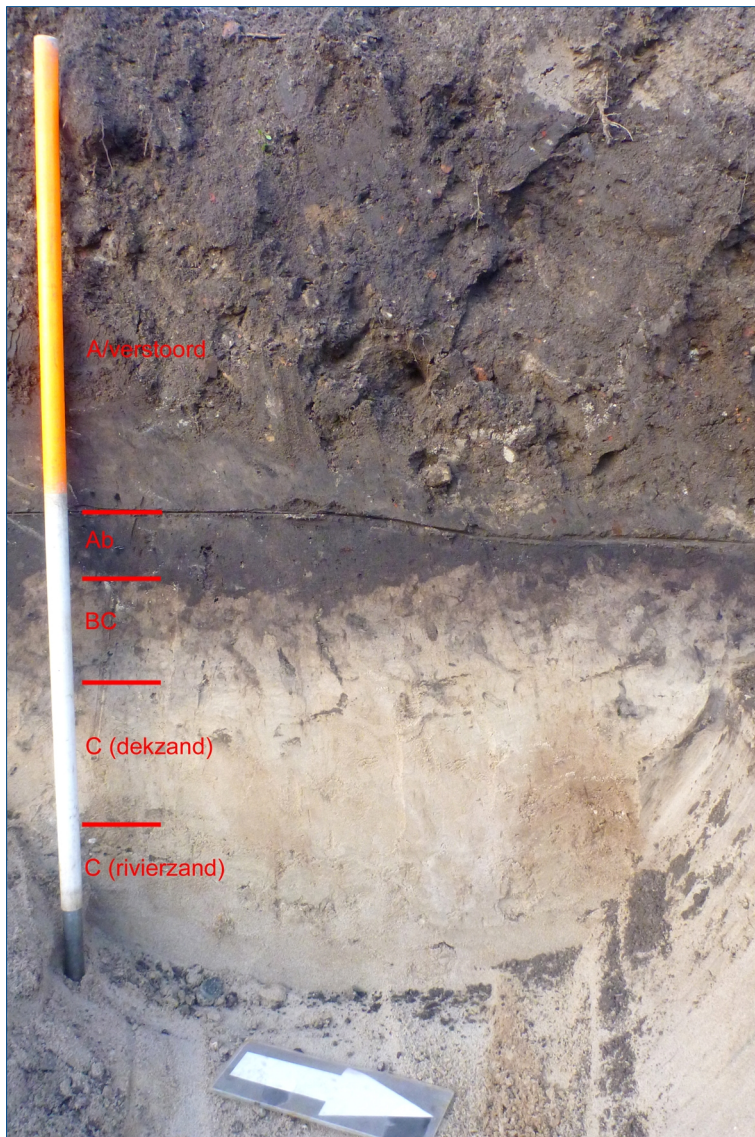
Figuur 4. Kolomprofiel 141 (put 1). Dit profiel is representatief voor de bodemopbouw in het noordelijk deel van het plangebied.
