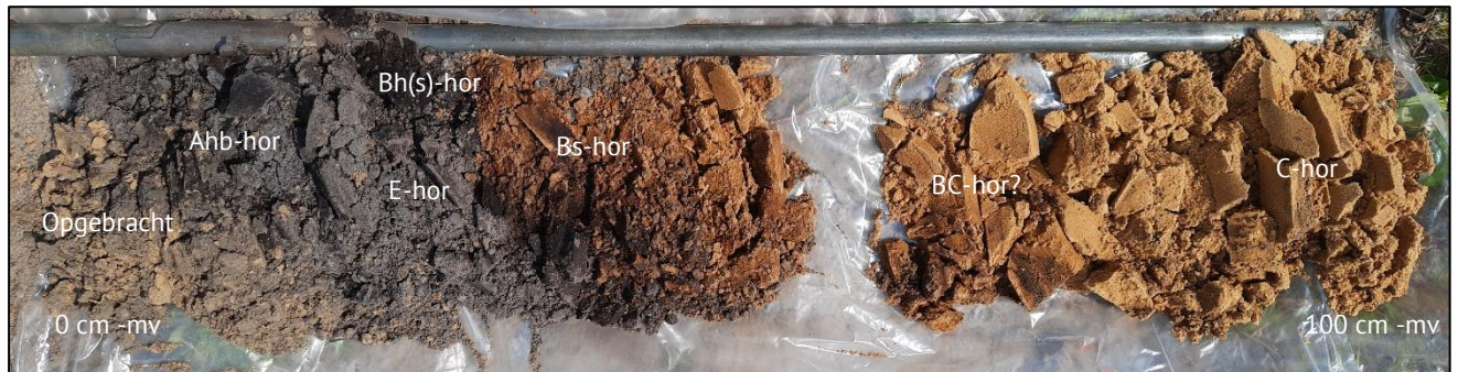
Figuur 7. Foto Type I boorprofiel van boring 34. Leesrichting is van links naar rechts (0 – 100): donker grijs opgebracht (sub-)recent pakket, matig humeus (donker) bruin grijs bouwvoor, grijze E-horizont, humeus bruin zand (B-horizont) die geleidelijk overgaat (BC-horizont) naar de (licht) gele kleur (C-horizont).
