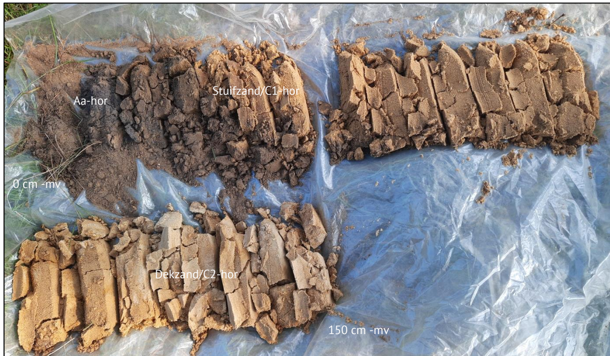
Figuur 10. Foto Type II boorprofiel van boring 60. Leesrichting is van links naar rechts (bovenste 150 centimeter): matig humeus donker bruingrijze A-horizont die scherp over gaat naar de (grijs)beige kleur (C-horizont).
