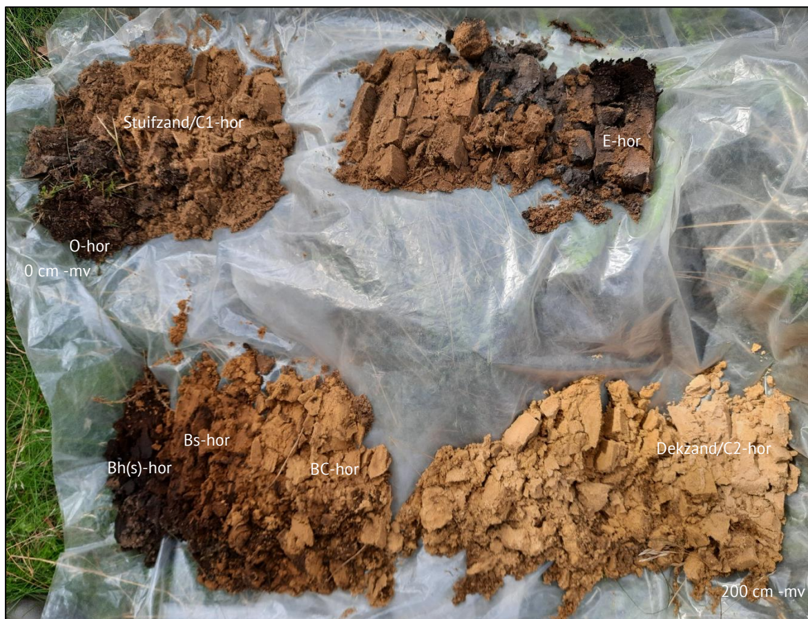
Figuur 8. Foto Type I boorprofiel van boring 87. Leesrichting is van links naar rechts (0 – 200): een onder een dikke laag vuil-lichtgrijs stuifzand op de begraven intact bodemprofiel.
