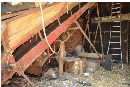
Afb. 40. en 41. De grote open ruimte met transportband om stro en hooi naar de zolder te transporteren (van beneden en boven gefotografeerd.)
