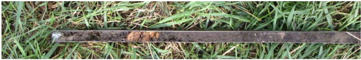
Figuur 13: Foto van boring 11 met het in deze boring aangetroffen veen.
