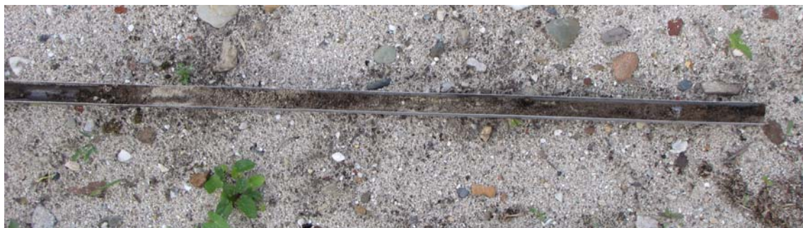
Figuur 12: Foto van boring 11 met daarin het uit brokken bestaande zandpakket zoals dat in de meeste boringen is aangetroffen.
