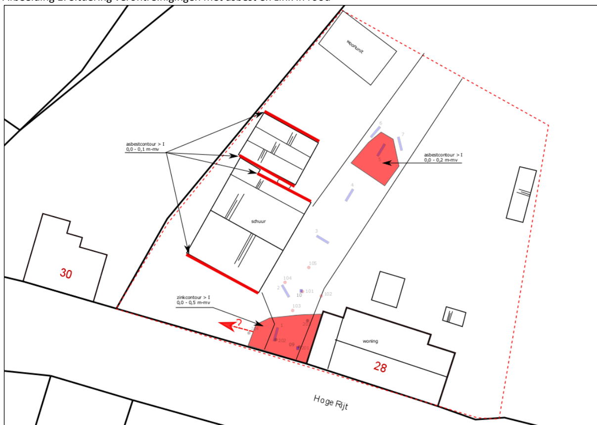
Afbeelding 1: Situering verontreinigingen met asbest en zink in rood
