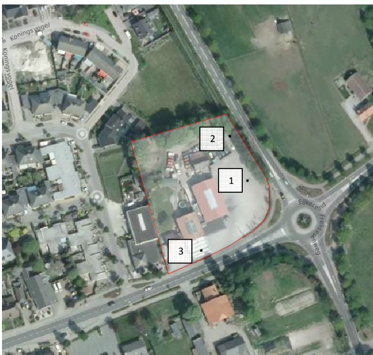
Figuur 3.1: Weergave risicopunten LPG-tankstation (zwarte punten): LPG-vulpunt (1), LPG-tank (2) en LPG-afleverpunt (3)
