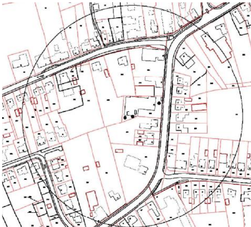
Figuur 3.1 Omgevingsplattegrond LPG-tankstation met invloedsgebied en: (B) Vulpunt LPG (C) LPG tank (D) Afleverzuil LPG
