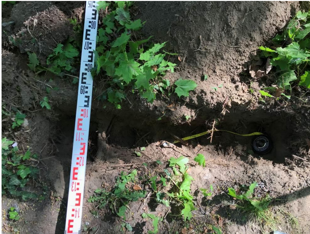
Figuur 9 Proefsleuf bij situatie A, 100 cm vanaf de stamvoet, met stabiliteitswortels ( \varnothing > 4 cm) vanaf 20 cm beneden maaiveld.
