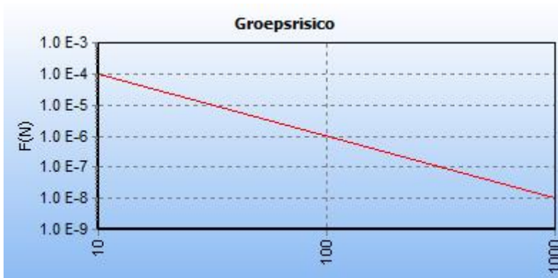
Afbeelding 6 fN-curve buisleiding Z-511-05-deel-1, huidige situatie
